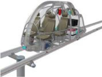
*Рельс-струна характеризуется высокой прочностью, жесткостью, ровностью, технологичностью изготовления и монтажа, низкой материалоемкостью (металл: 5—10 кг/м), широким диапазоном рабочих температур (от +70 до -70 °С).*
