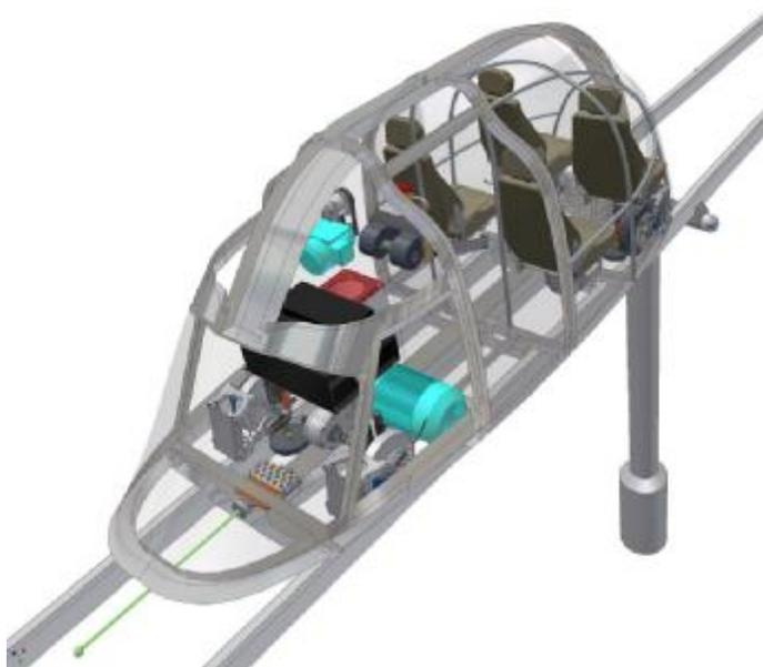
Рис. 4. Компоновка высокоскоростного юнибуса Ю-315РЕ
