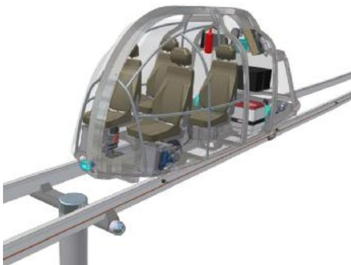
Рис. 3. Компоновка высокоскоростного юнибуса Ю-315РЕ
